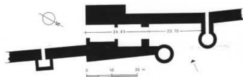
La porte D de Mantinée et sa succession d'obstacles permettant une forte concentration de défenseurs sur toute la longueur du parcours. Dessin J.-P. Adam.
